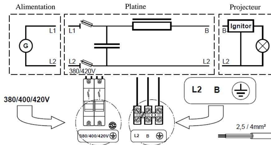
Distances platine - projecteur à respecter : max 50m (câble de section 2,5mm<sup>2</sup>), max 80m (câble de section 4mm<sup>2</sup>)
